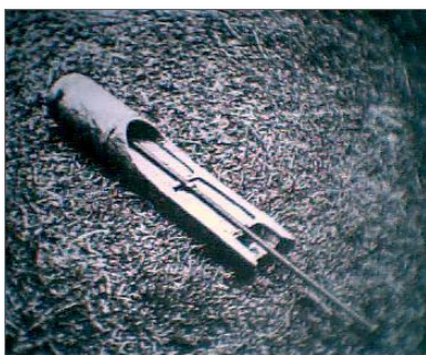
Figura 3.7: Unión de tornillo axial: Recortada para mostrar la ubicación de las tuercas de retención y como el mortero constituye un embolo que es retenido por el tabique.
