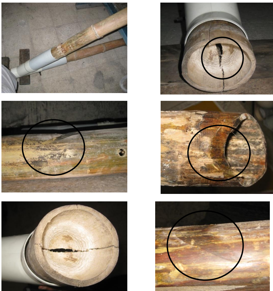
Figura 5.20: falla por aplastamiento en la guadua
