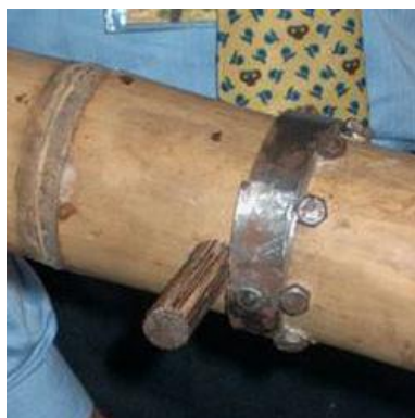
Figura 3.36: unión con tornillos Trujillo-Ortiz
