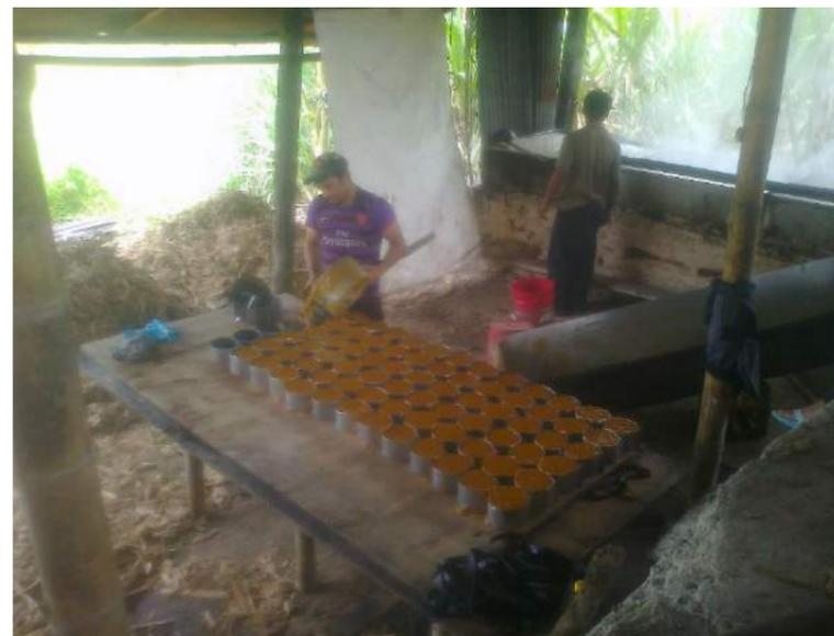
Imagen 13: Colocación en los moldes. Fuente: Autor del trabajo de graduación.
