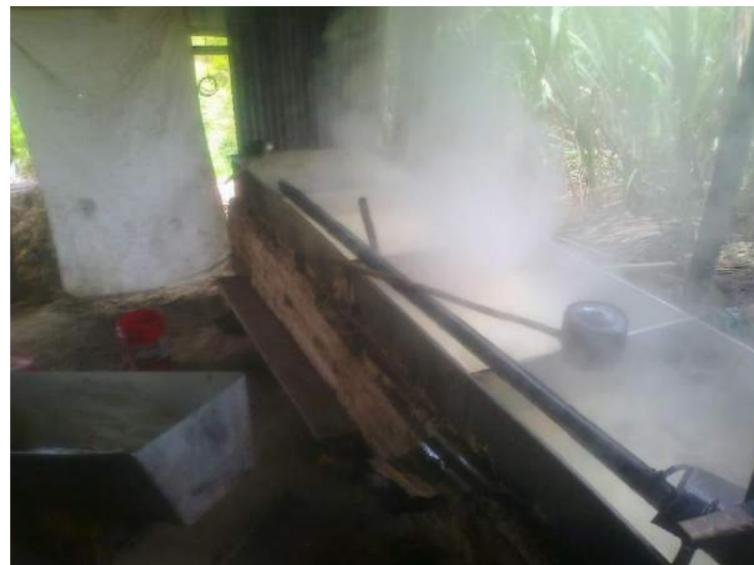
Imagen 11: Calderas para la producción de panela. Fuente: Autor del trabajo de graduación.
