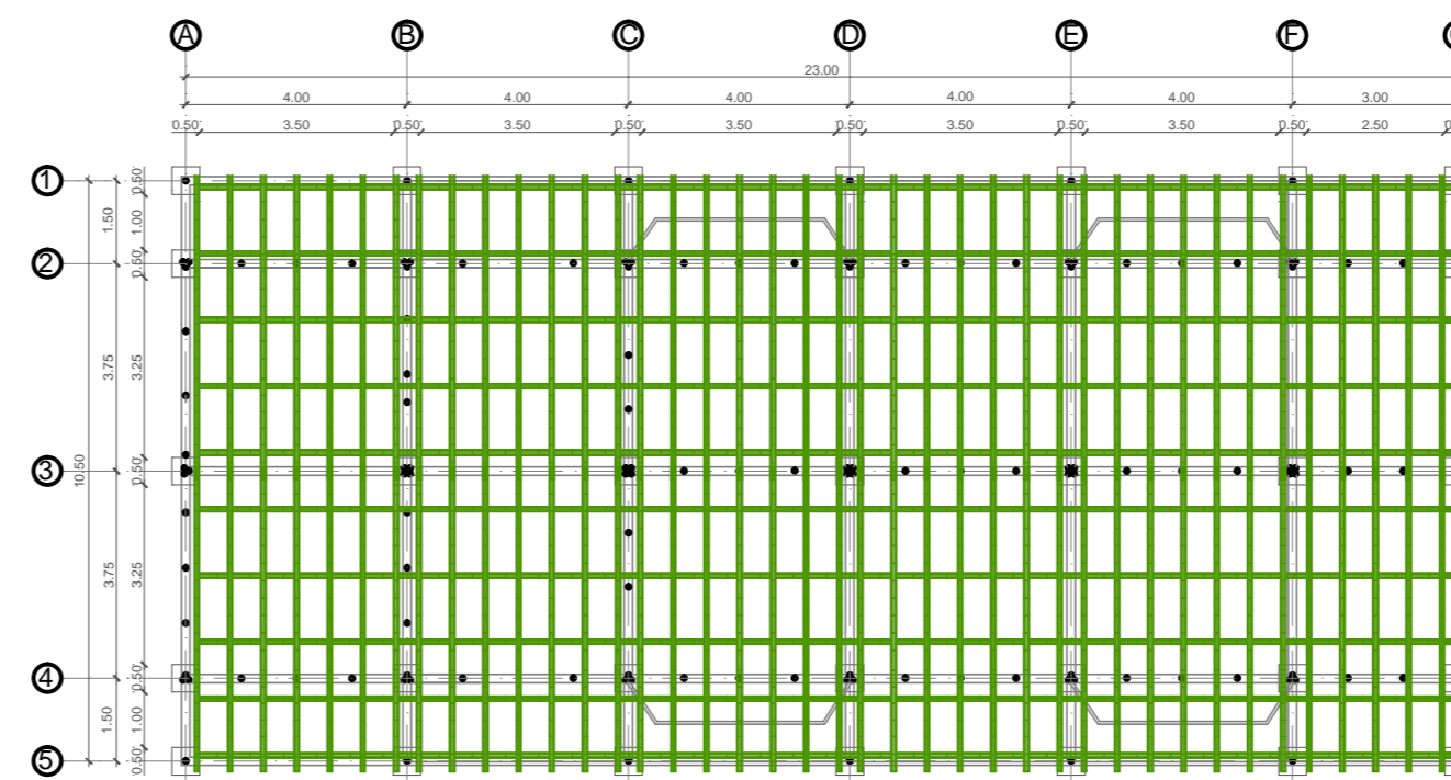
PLANTA CIMENTACIÓN ESCALA 1:150
