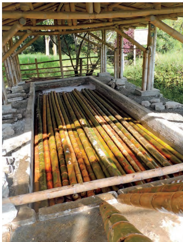
Proceso de inmersión de culmos de guadua en tanque de preservación
