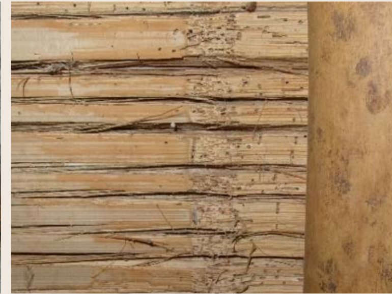
Figura 8: Daño causado por escarabajo en el bambú, Colombia – los agujeros de salida son claramente visibles
