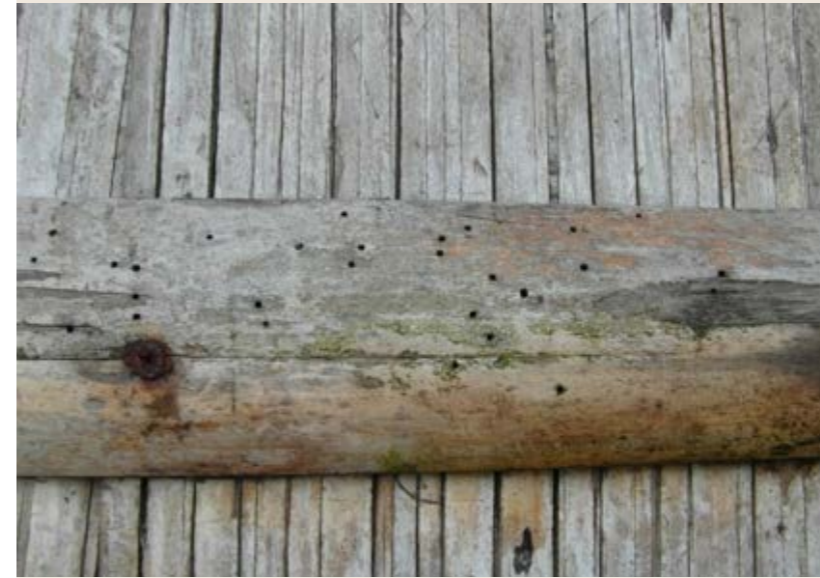
Figura 7: Daño causado por escarabajo en el bambú, Ecuador – los agujeros de salida son claramente visibles.
